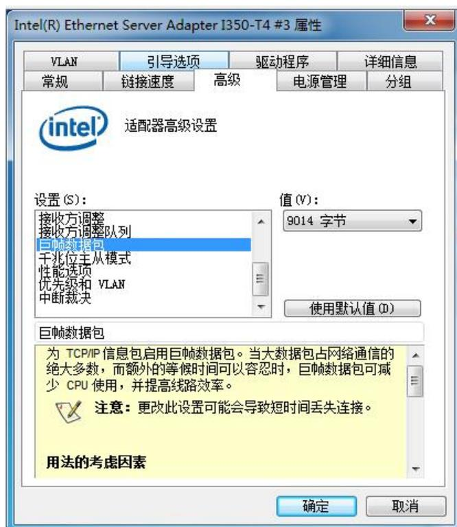
→点击“高级”选项卡中的“性能选项”，点击属性，将“传输缓冲区”的值修改为最大值，图中最大值为“2048”
