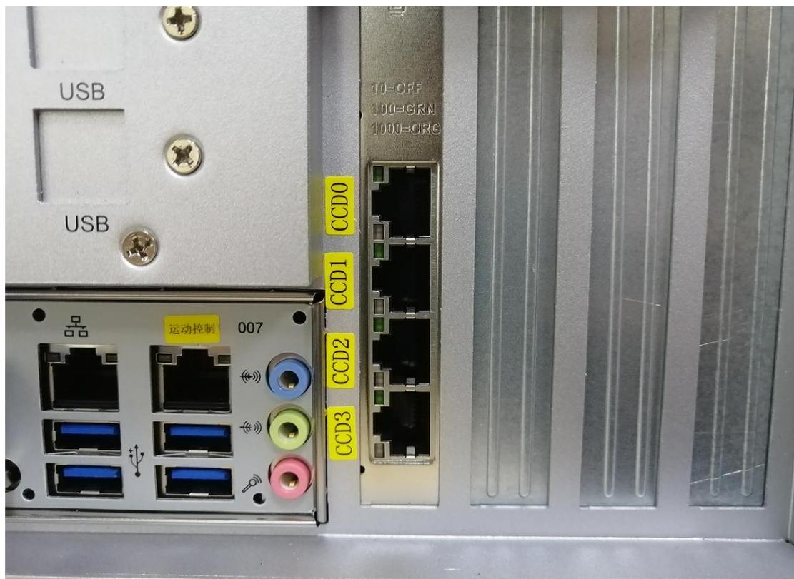
4, 如有外接的光源控制器, 则需要贴好光源控制器通讯的 COM 口标签;
