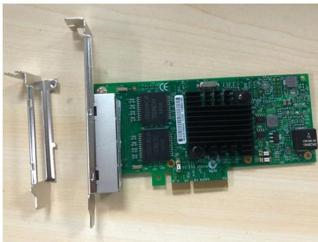
→将网卡插入 PCIe 插槽，锁螺丝固定好
